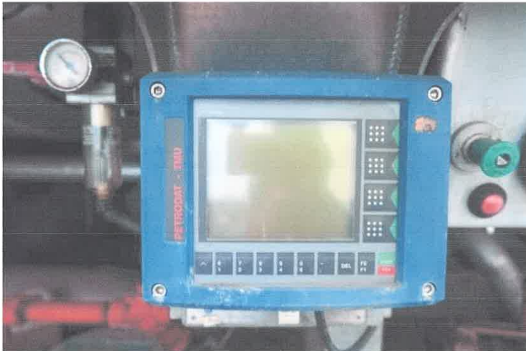
13 System dystrybucyjno - pomiarowy.
